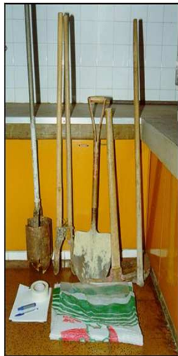
Equipamentos para prospecção de jazidas. Fonte: Teixeira, 2012.
