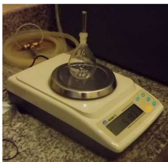
Pesagem do picnômetro seco. Pesar também o picnômetro com solo e adicionar água até a metade do volume do picnômetro.
