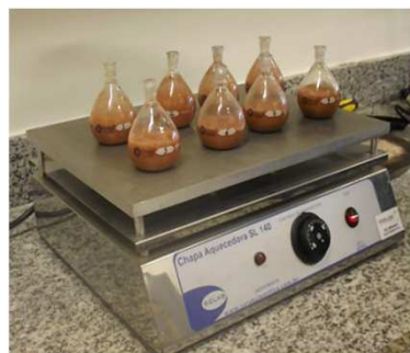
Processo de fervura em chapa aquecedora. Em seguida, resfriamento em água gelada na bacia plástica.
