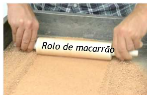
Destorroamento do solo.
