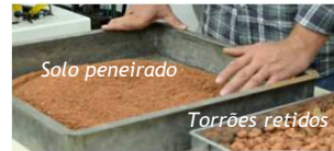
Metade do solo sendo armazenado e metade peneirado.
