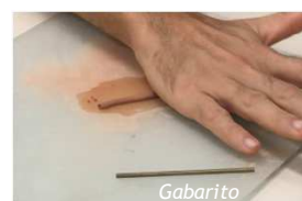
Moldagem e rolagem da forma elipsoidal.
