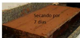
Lançamento do solo, processo de rasamento e solo em repouso.
