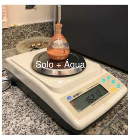
Pesagem do picnômetro com solo e água.
