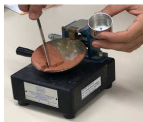
Retirada do solo onde as ranhuras se tocam
