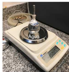
Pesagem do picnômetro cheio de água.
