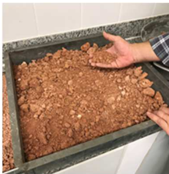
Solo secando em área coberta e ventilada.
