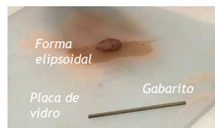
Moldagem e rolagem da forma elipsoidal.
