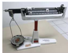
Pesagem das cápsulas vazias e com solo.
