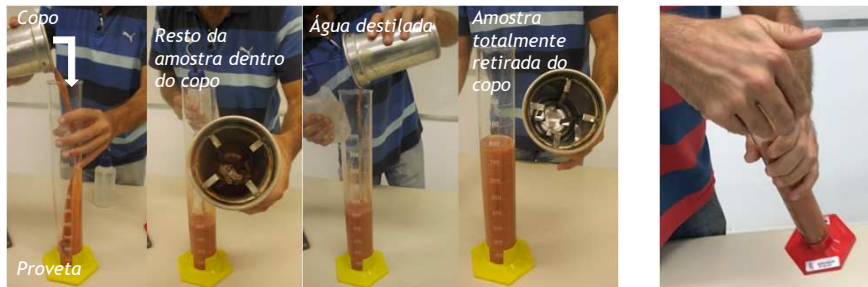
Agitar a mistura por 1 minuto e realizar a leitura com densímetro.
