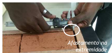
Medição do afastamento com paquímetro digital.
