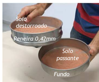
Passar solo destorroado peneira 0,42mm
