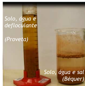
Solo de "molho" em água com sal e com defloculante.
