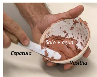
Homogeneização da massa de solo com água
