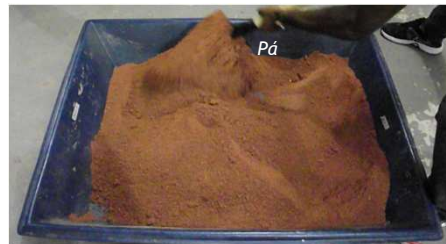
Solo sendo misturado até homogeneização.
