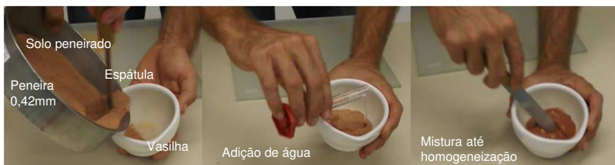
Homogeneização do solo com água.
