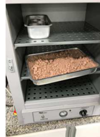
Secagem do solo na estufa.
