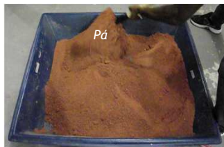
Homogeneização e quartearamento do solo.
