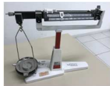
Pesagem das cápsulas vazias e com solo.
