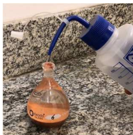
Completar o picnômetro com água destilada.
