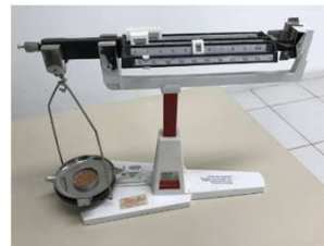
Levar amostra para estufa, retirar e pesar após 24h.
