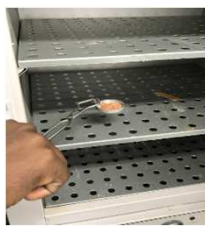
Levar amostra para estufa, retirar e pesar após 24h.
