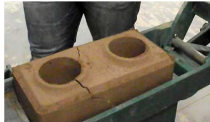
Problemas na retirada do tijolo.
