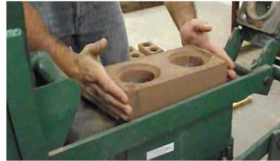
Detalhe da retirada do tijolo.
