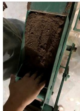
Detalhe do adensamento manual.
