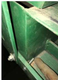
Parafuso-trava atrás da gaveta.
