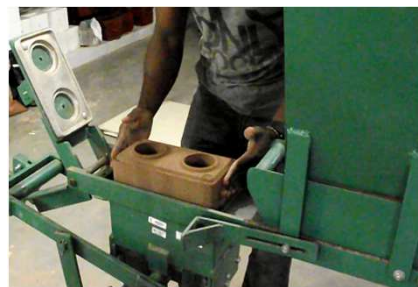
Retirada do tijolo da prensa.
