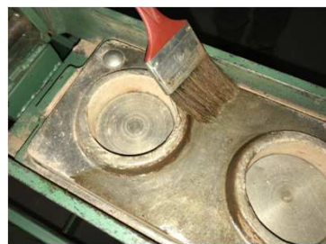
Lubrificação dos moldes.
