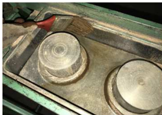
Lubrificação da câmara de prensagem.
