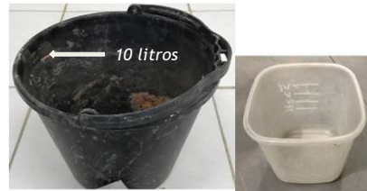
Marcações no balde e no recipiente do cimento e da cal.
