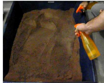
Adição de água.
