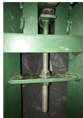
Parafuso de ajuste vertical da prensa.
