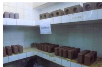
Cura em câmara úmida
