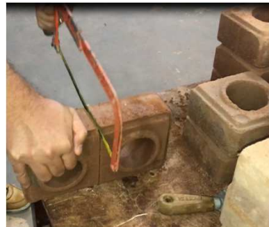
Corte do tijolo fresco (meio tijolo).
