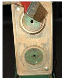
Limpeza dos resíduos nos moldes.
