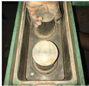
Cilindros fixados na prensa.
