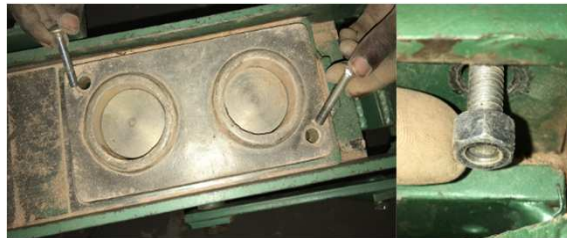
Fixação dos moldes na prensa.
