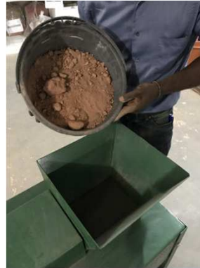
Destorroamento do solo.
