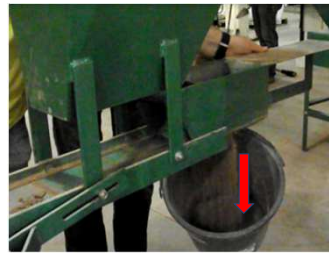
Retirada do material da gaveta por trás.
