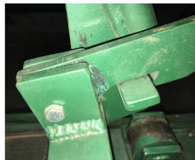
Levantar a alavanca até o acionamento da trava.
