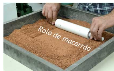
Destorroamento manual com rolo de macarrão.
