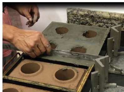
Capeamento do tijolo inteiro (resultados em termos de resistência do CP foram cerca de 10% menores e maior dispersão).
