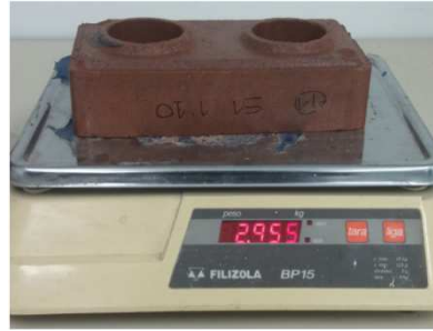
Medição da massa do tijolo saturado.
