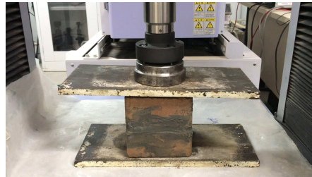
Ensaio de resistência à compressão.
