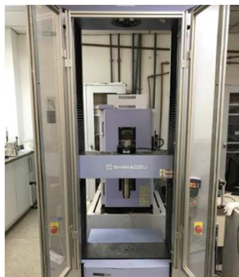
Máquina de ensaio à compressão com capacidade 100kN.
