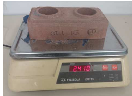
Medição da massa seca do tijolo.
