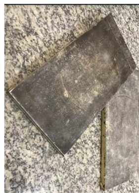
Chapas de aço como pratos de apoio da prensa.
