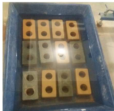
Submersão dos corpos de prova em água.
