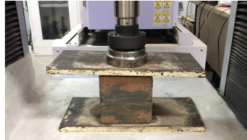
Teste de resistência à compressão.
